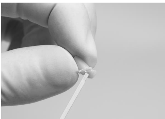
Figur 5 – Icke-polymeriserat material skrapas bort från provbiten
