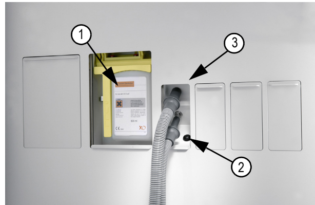
Imagen 17 Limpieza del sistema de aspiración
