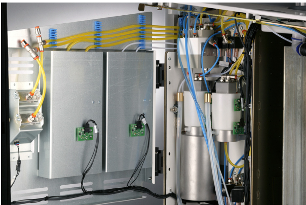
Imagen 27 Acceso al separador de amalgama
