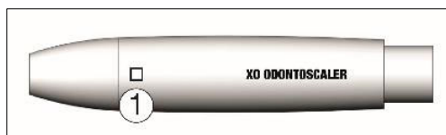
Figure 23 - Pièce à main XO ODONTOSCALER : (1) Marque du filetage de la pointe du type
