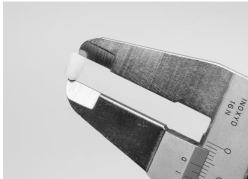
Figure 78 - Mesure de la profondeur de la fiche de test
