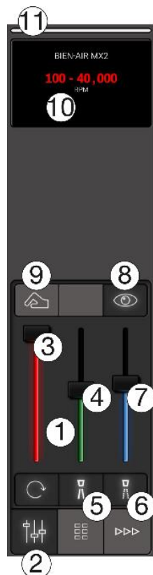
Figure 10 - Commande de base de l'instrument : (1) Fenêtre de contrôle de l'instrument, (2) bouton d'ouverture et de fermeture de la fenêtre de l'instrument, (3) curseur de vitesse, (4) curseur de l'eau de pulvérisation, (5) bouton de sélection de l'eau de pulvérisation, (6) bouton de sélection de l'air de pulvérisation, (7) curseur de l'air de pulvérisation, (8) bouton d'activation/désactivation du soufflage automatique des copeaux, (9) bouton d'activation/désactivation de la fonction "tactile", (10) affichage de l'instrument et (11) indicateur de sélection de l'instrument.
