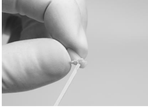
Figure 77 - Le matériau non polymérisé est retiré du dispositif d'essai composite.
