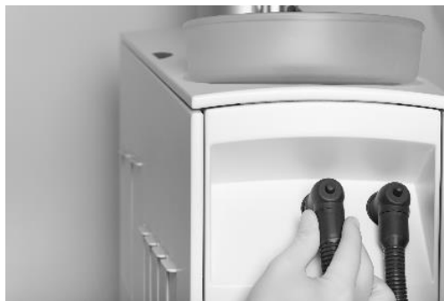
Figure 88 - Démontage des filtres d'aspiration
