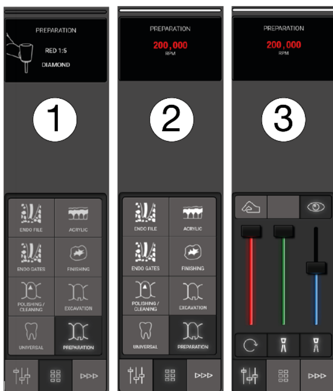
Figure 19 - Préréglage : (1) Préréglage activé, (2) instrument activé et (3) contrôle et réglage du préréglage
