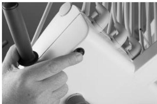
Abbildung 59 - Konfigurationstaster (1) an der Unterseite der Instrumentenbrücke
