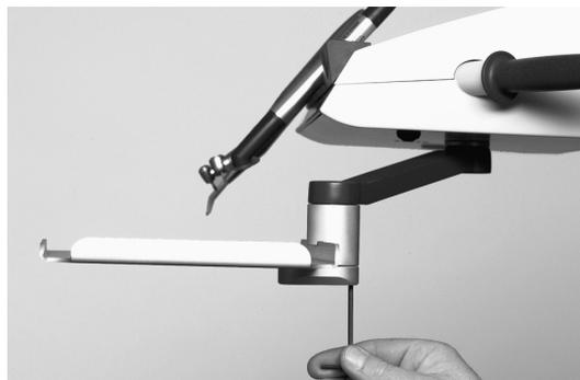
Abbildung 82 - Justierung der Handinstrumentenablage
