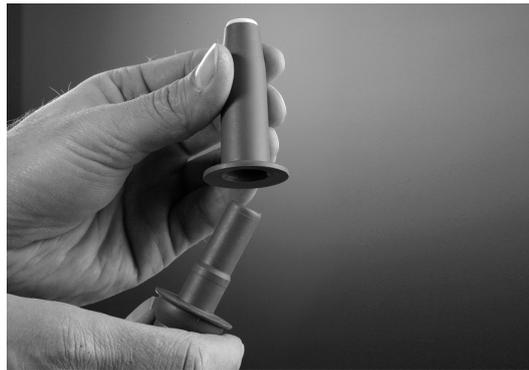
Abbildung 69 - Abnehmen der Kappen der Saugschlauchansätze
