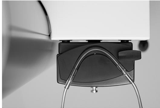
**Abbildung 32 - Anbringen des Spülschlauchs**
