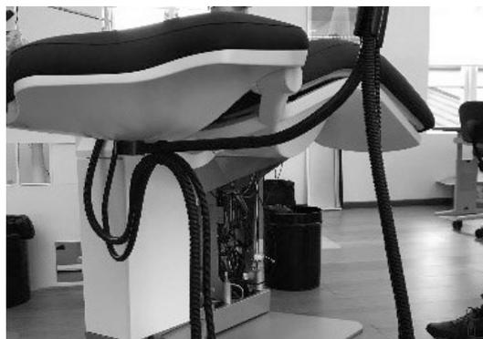
**Abbildung 55 - Anbringung der Saugschläuche**
