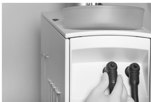
Abbildung 71 - Abnehmen von Saugschläuchen und Filtern
