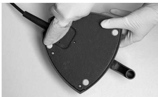
Abbildung 77 - Reinigung der „Gummifüße“ des Fußanlassers
