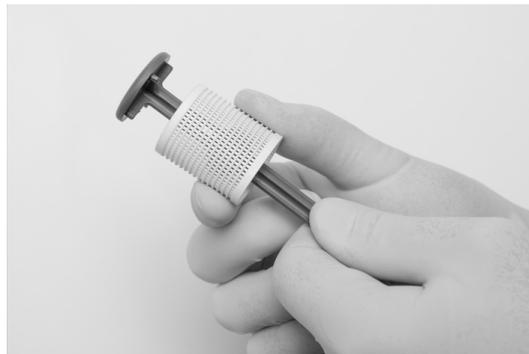
Abbildung 73 - Entfernen der Filterpatrone aus dem Filterhalter
