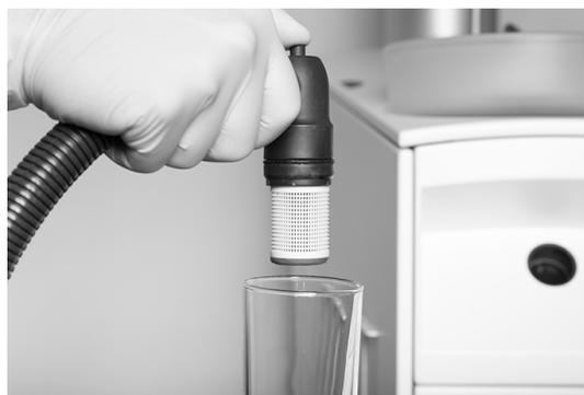
Figure 72 – Éjection du porte-filtre
