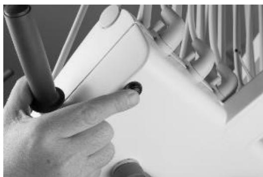
**Figure 39 - Sélection de l'instrument à utiliser avec la pompe péristaltique XO**
