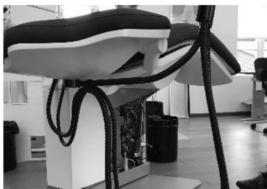
**Figure 55 – Fixation des tuyaux au support Ambidex**
