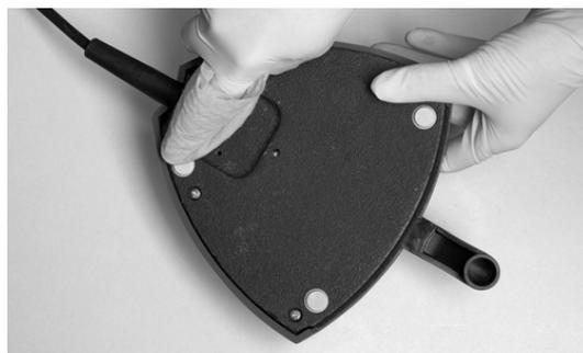
Figure 77 - Nettoyage des butées en caoutchouc de la pédale de commande
