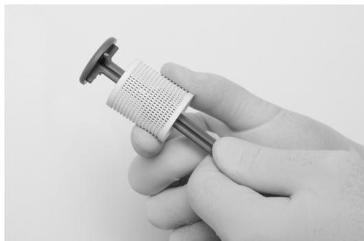
Figure 73 - Retrait du filtre du porte-filtre
