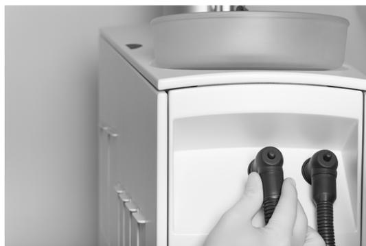
Figure 71 - Retrait des tuyaux et filtres d'aspiration
