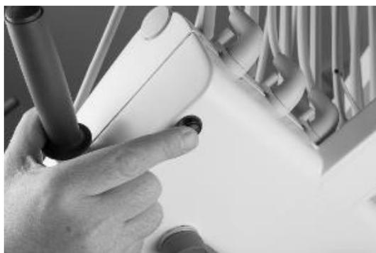
Figure 59 - Bouton de configuration (1) sous la Console-instruments
