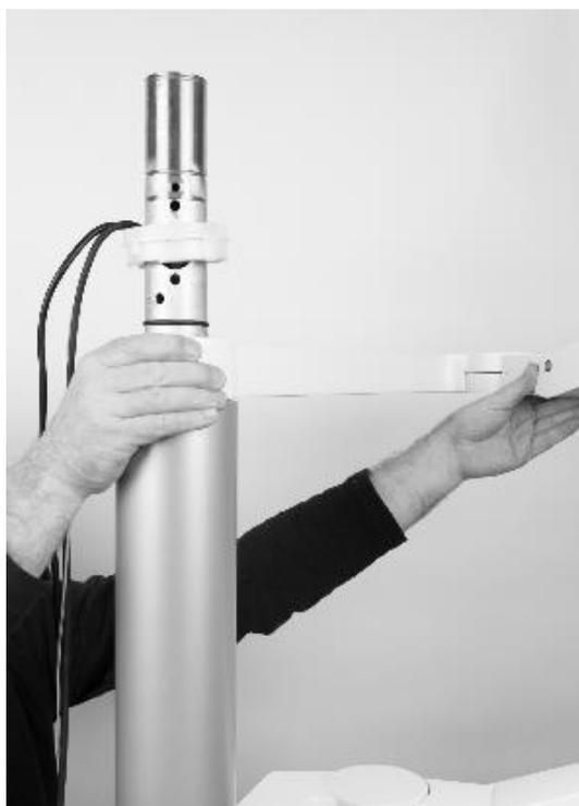
**Abb.46 – Einbau des Displayarms**
