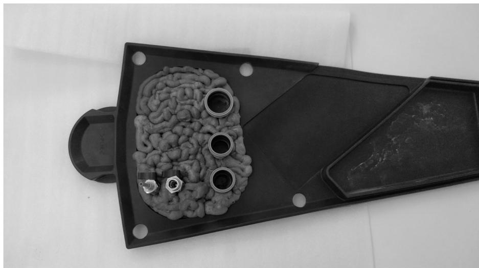
Abb. 13 – Versiegelung der Installationsöffnung mit flammhemmendem Schaum
