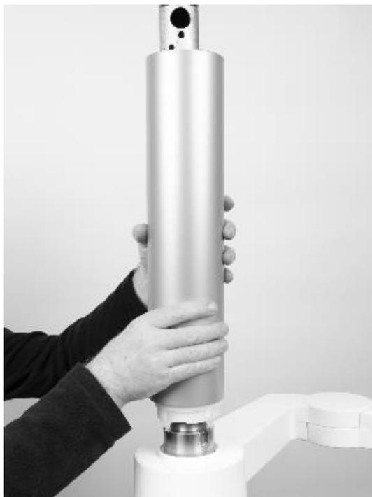
**Abb.45 – Einbau des unteren Außenzylinders**
