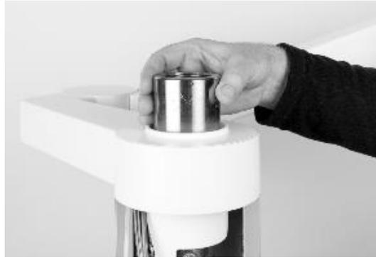
**Abb.36 – Montage der Mutter auf der Brückenaufbaustange**
