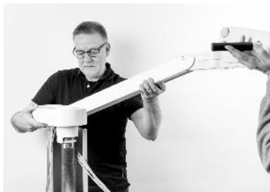
**Abb.26 – Montage des Instrumentenarms**
