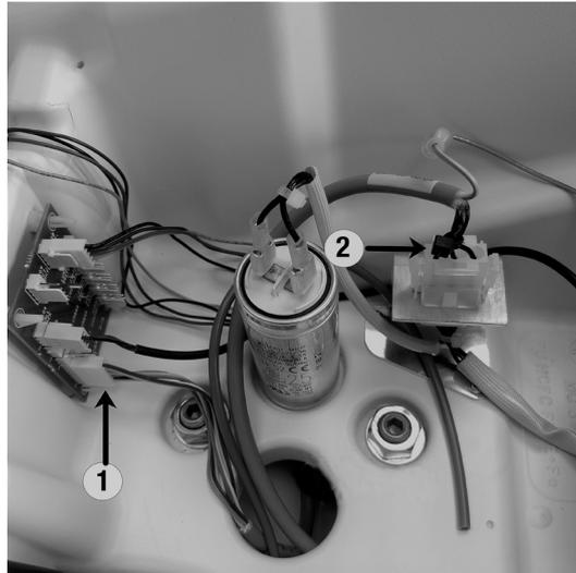
Abb. 59 – Anschluss der Kabel: (1) Steuerkabel, (2) Stromversorgung
