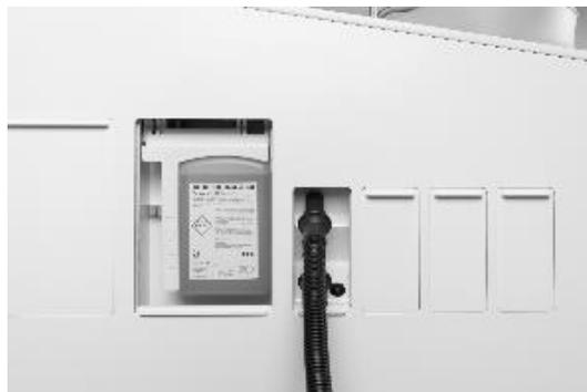
Abb. 62 – XO Suction Disinfection Kartusche. Beachten Sie, dass der Verriegelungsgriff gelb ist.
