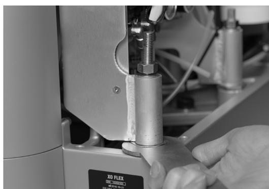
**Abb. 17 – Ausrichten des Standkörpers**
