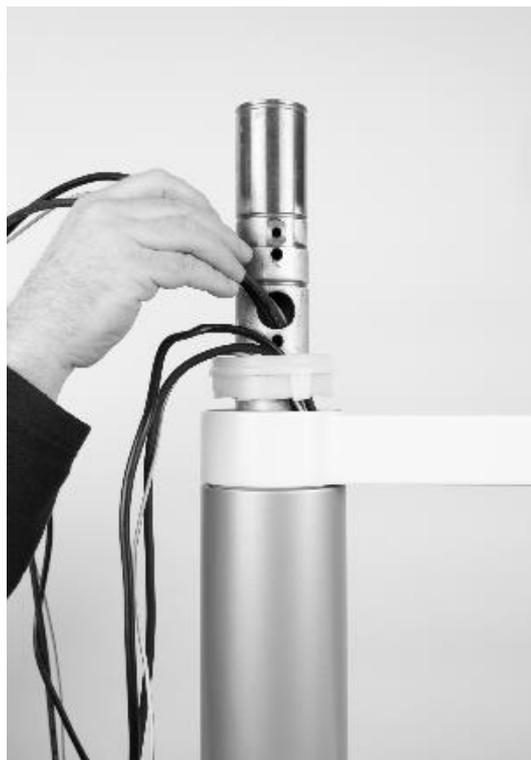
**Abb.47 – Verlegen der Displaykabel**
