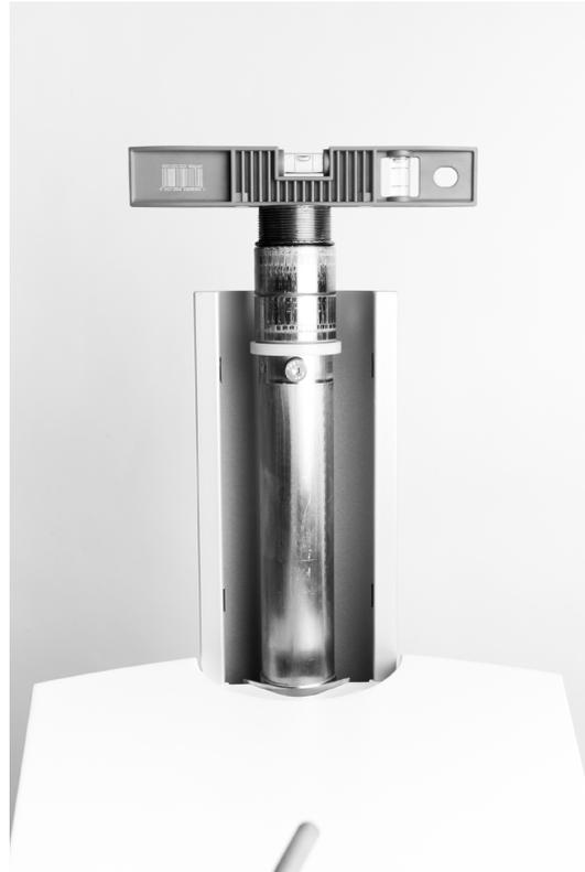
Abb. 21 – Einstellung des Standkörpers in Querrichtung (B)
