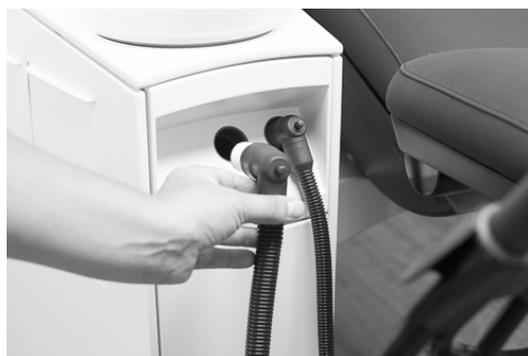
Abb.52 – Anschluss der Saugschläuche
