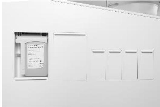
Figure 61 – Emplacement du bidon XO Water désinfection. Côté poignée blanche
