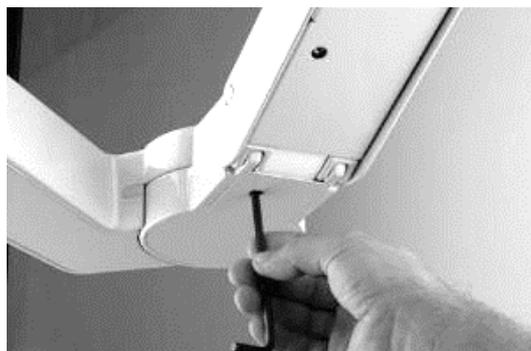
Figure 68 – Réglage du ressort de l'équilibre situé dans l'avant-bras du porte-instruments
