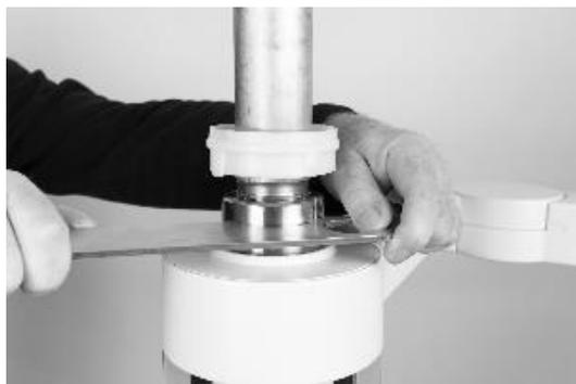
Figure 38 – Serrage finale de l'écrou
