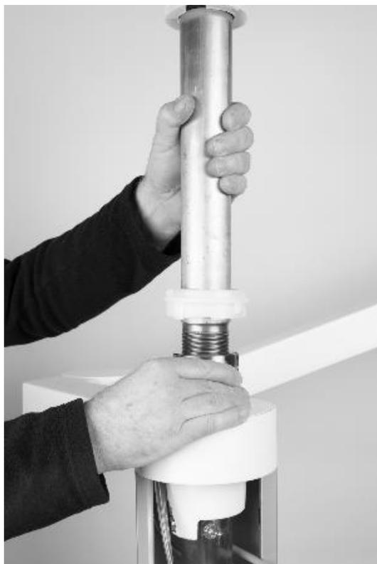
Figure 37 – Colonne du scialytique posée sur l'écrou
