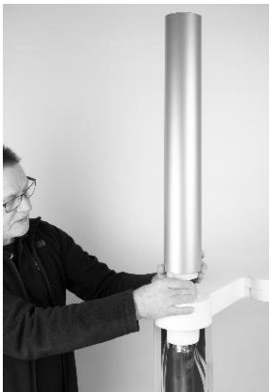
Figure 39 – Montage du cache cylindrique sur la colonne du scialyrique
