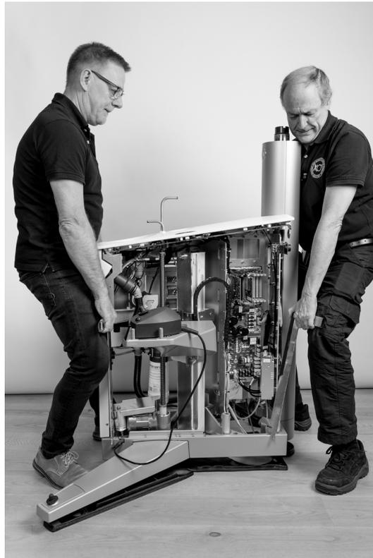
**Figure 16 – Positionnement de l'Unit avec les poignées de transport**
