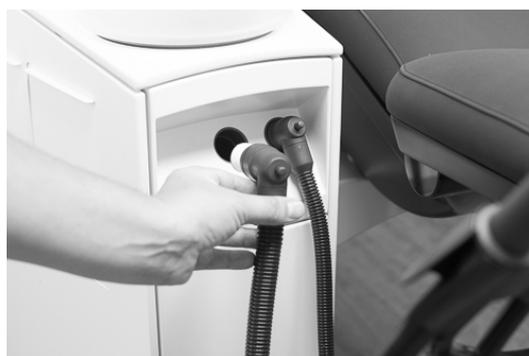
Figure 52 – Raccordement des tuyaux d'aspiration
