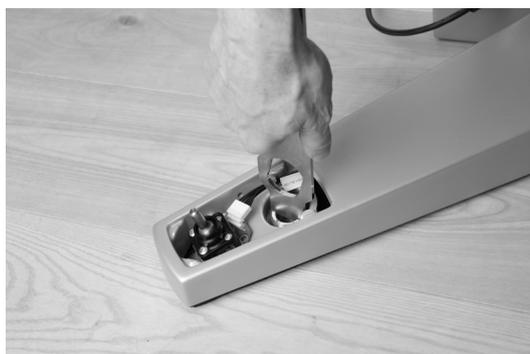
Figure 23 – Réglage de la béquille
