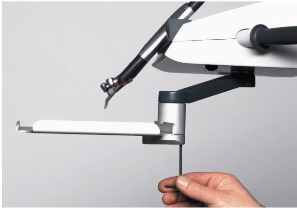
Figur 34 Justering av brickbordet
