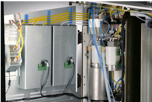
Figur 27 Åtkomst till amalgamseparatorn
