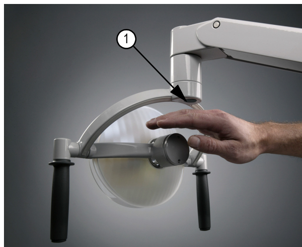
Figur 9 Aktivering av op-belysning
