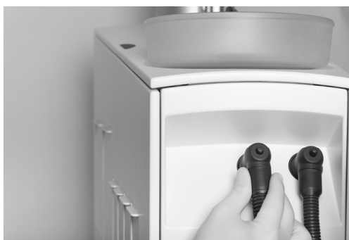
Figur 70 - Borttagning av sugslangar och -filter
