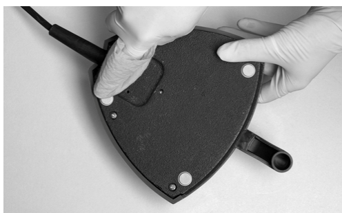
Figur 76 - Rengöring av fotkontrollens "gummifötter"
