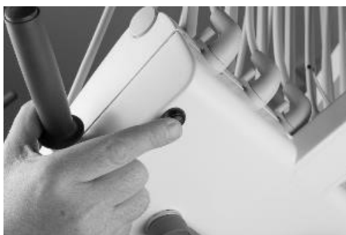
Figur 38 - Initiera val av instrument att användas med XO-peristaltikpumpen
