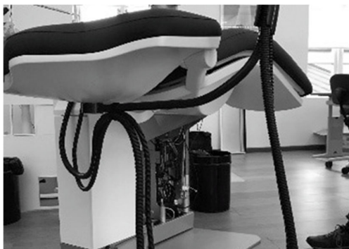
Figur 54 - Fästning av sugslangar
