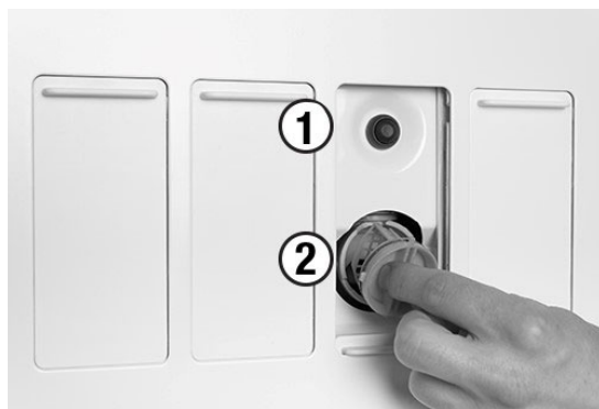
Figur 83 - Manuell aktivering av spottkopsventilen (1) och spottkopsventilens filter (2)
