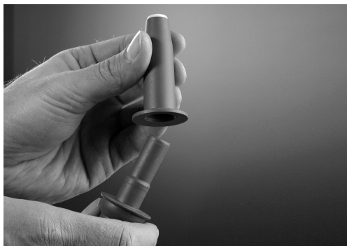
Abbildung 68 – Abnehmen der Kappen der Saugschlauchansätze
