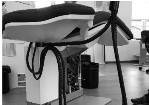
Abbildung 54 – Anbringung der Saugschläuche
