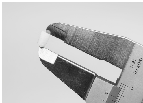
Abbildung 80 - Messung der Tiefe des Prüfstopfens
