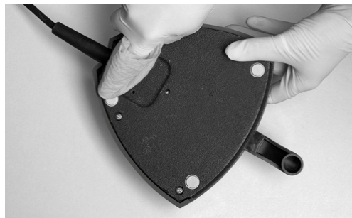
Abbildung 76 – Reinigung der „Gummifüße“ des Fußanlassers
