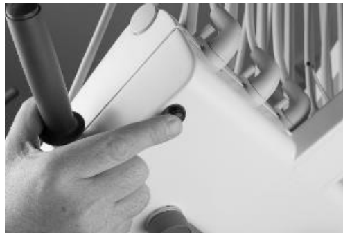
Abbildung 58 – Konfigurationstaster (1) an der Unterseite der Instrumentenbrücke
