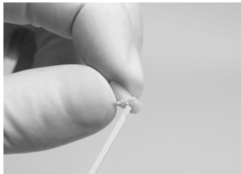
Abbildung 79 – Nicht polymerisiertes Material wird vom Komposit-Probekörper entfernt
