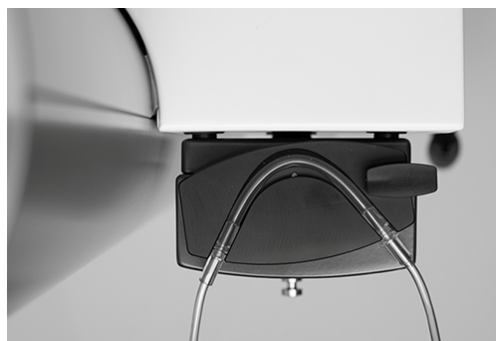
Abbildung 31 - Anbringen des Spülschlauchs
