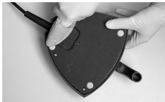
Figur 77 - Rengöring av fotkontrollens "gummifötter"
