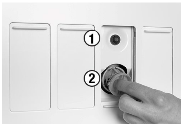
Figur 84 - Manuell aktivering av spottkopsventilen (1) och spottkopsventilens filter (2)
