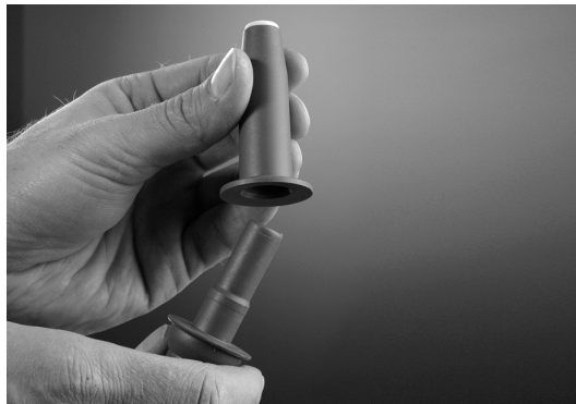
Figur 69 - Borttagning av sugmunstyckenas täckkåpor
