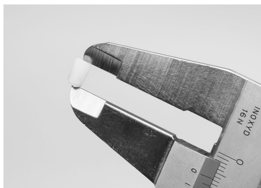
Figur 81 - Mätning av djupet av testpluggen
