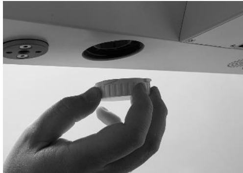
Abbildung 70 - Zugang zum Ölabscheider
