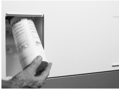
Abbildung 94 - Auswechseln der Wasserenthärterpatrone
