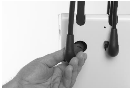
Abbildung 65 - Abnehmen des Instrumentenschlauchs
