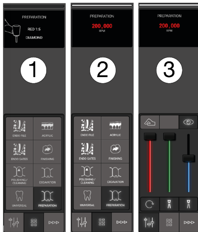
Abbildung 19 - Voreinstellung: (1) Preset aktiviert, (2) Instrument aktiviert und (3) Überwachung und Einstellung des Presets
