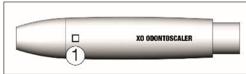
Abbildung 23 - XO ODONTOSCALER Handstück: (1) Markierung des Instrumentengewindetyps
