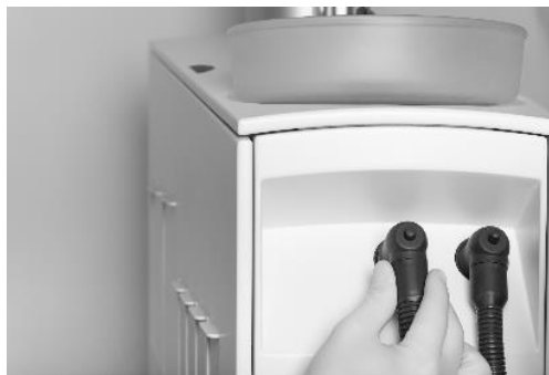
Abbildung 88 - Ausbau der Saugfilter
