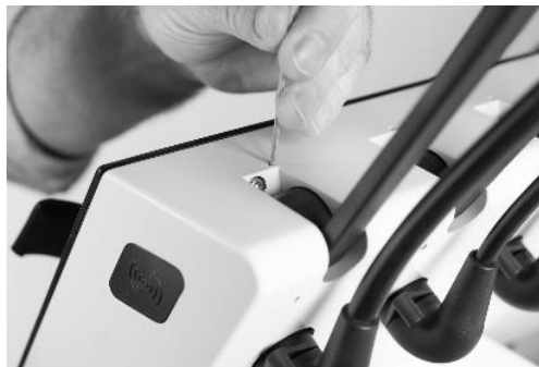
Abbildung 84 - Einstellen des Winkels des Instrumentenarms
