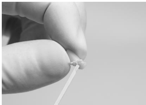
Abbildung 77 - Unpolymerisiertes Material wird aus dem Verbundwerkstoff-Prüfgerät entfernt
