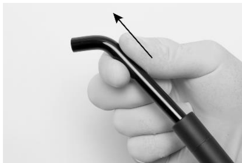
Abbildung 75 - Entfernen des Lichtstabs vom XO ODONTOCURE Handstück
