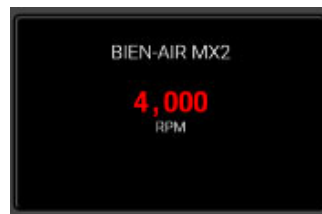
Abbildung 12 - Gerätedisplay mit Anzeige der aktuellen Mikromotordrehzahl
