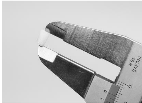
Abbildung 78 - Messen der Tiefe des Prüfstopfens
