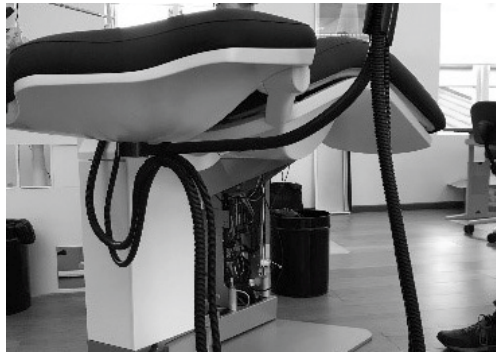
Abbildung 40 - Anbringung der Saugschläuche
