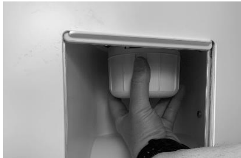
Abbildung 93 - Auswechseln des Amalgamauffanggefäßes
