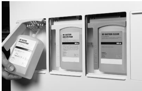
Abbildung 95 - Reinigungs-/Desinfektionspatronen: (1) XO Wasserdessinfektion und (2) XO-Saugdesinfektion
