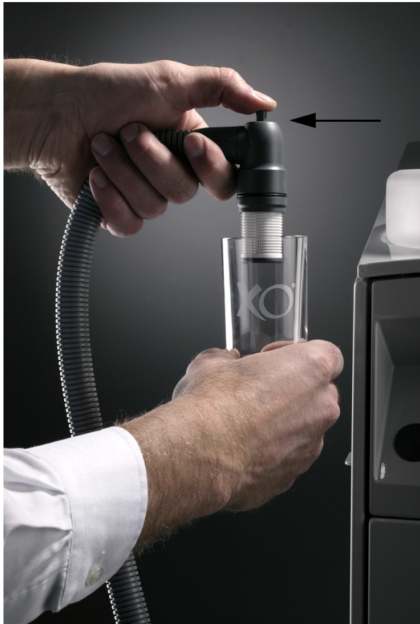
Figur 19 Tryk på knappen for at skubbe filtret ud
