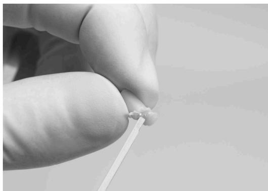
Figura 80 – Materiale non polimerizzato rimosso dal tappo di prova del composito
