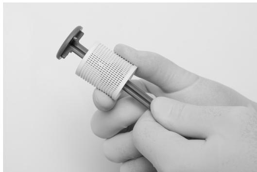
Figura 73 – Rimozione della cartuccia del filtro dal supporto
