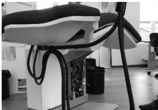
Figure 55 – Fissaggio dei tubi al supporto Ambidex
