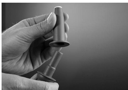
Figura 69 – Rimozione dei cappucci dai terminali dei tubi
