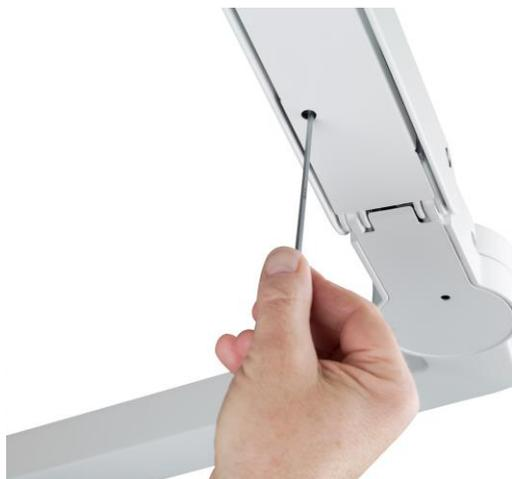
2. Regolazione del freno di attrito del giunto di rotazione del braccio lampada OP/schermo, movimento orizzontale.
