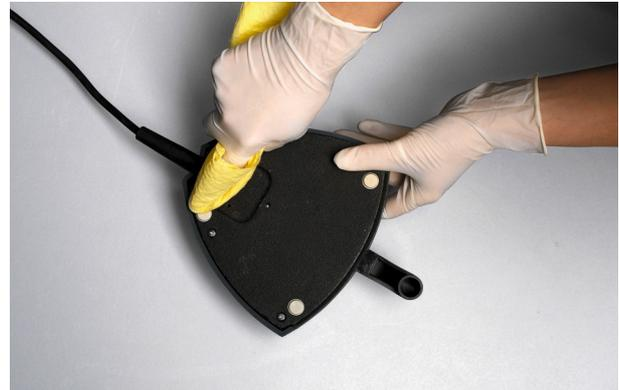
**Figure 33** Nettoyage des pieds en caoutchouc
