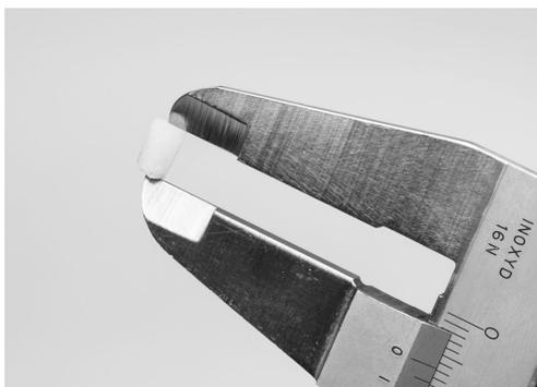
**Figura 80 – Misurazione della profondità del tappo di prova**
