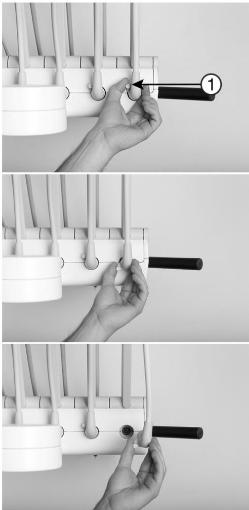
**Figura 63 – Rimozione del tubo dello strumento, (1) leva di sblocco**
