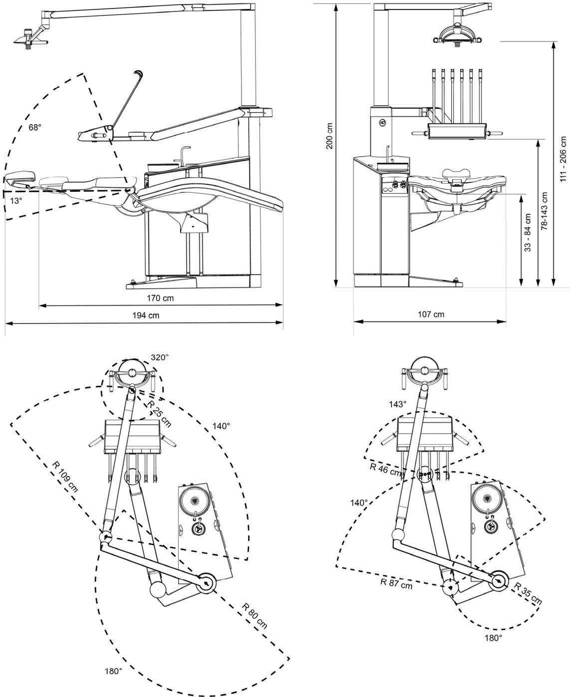
Figura 85 – Dimensioni di XO FLEX e ampiezza di movimento
