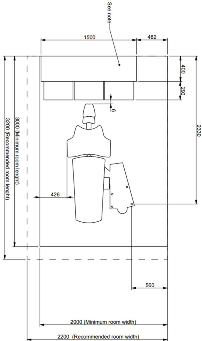
**Figura 1 – Disegno di installazione – XO FLEX**
