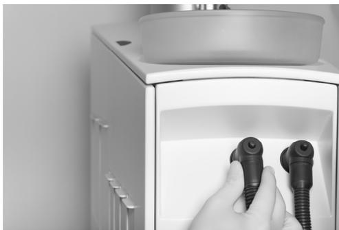
**Figura 70 – Rimozione dei tubi di aspirazione e dei filtri**
