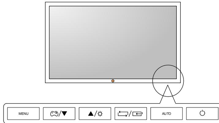
**Figura 49 – Pulsanti del pannello di controllo – display HD**
