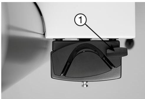
**Figura 30 – Rilascio della testa della pompa**
