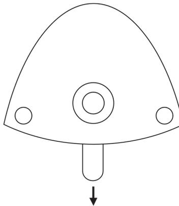
**Figura 48 – Controllo a pedale opzionale della lampada**
