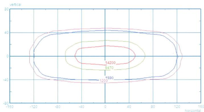
**Figura 86 – XO Light – Linee di contorno per fascio di illuminazione corrispondenti a 10%, 50% e 75% dell'illuminazione massimo**
