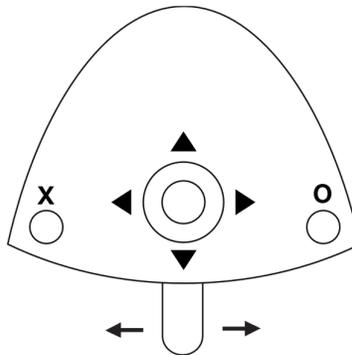
Figura 21 – Comando a pedale della turbina
