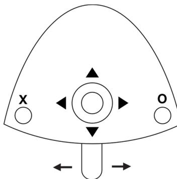
**Figura 20 – Controllo a pedale del micromotore**
