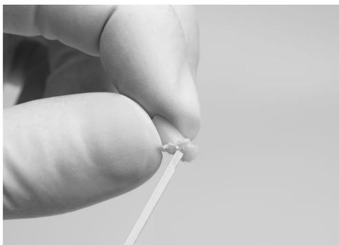
**Figura 79 – Materiale non polimerizzato rimosso dal tappo di prova del composito**
