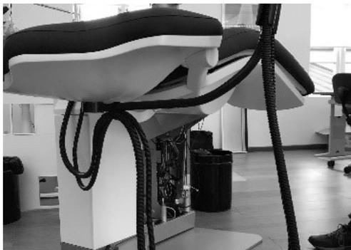
**Figure 54 – Fissaggio dei tubi al supporto Ambidex**
