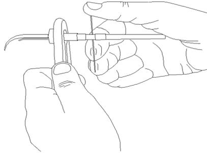
**Figura 77 – Stringere / cambiare la barra in ferrite**
