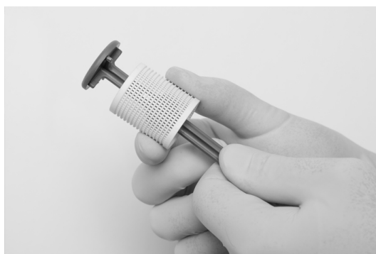
Figur 73 – Fjernelse af filterpatronen fra filterholderen
