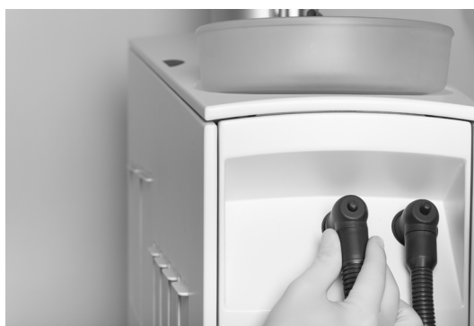
Figur 71 – Fjernelse af sugeslanger og filtre
