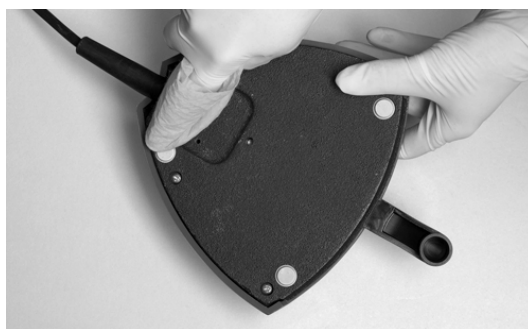
Figur 77 – Rensning af fodkontaktens “gummifødder”
