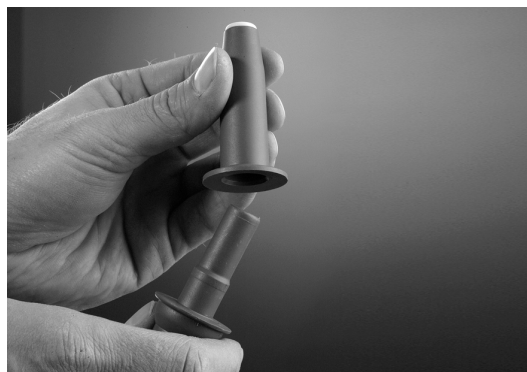
Figur 69 – Fjernelse af yderkappe på sugeslange dyse
