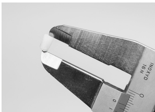
Figure 80 - Mesure de la profondeur du bouchon d'essai
