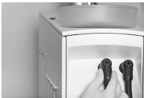
Figure 70 - Retrait des tuyaux et filtres d'aspiration
