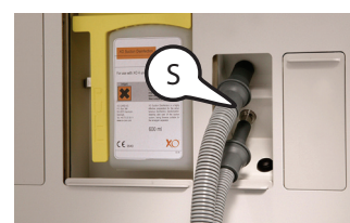
Afzuigslangen bevestigd aan nippels ter desinfectie
