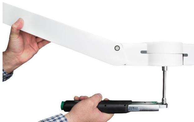
5. Après vérification de la vis centrale, serrer les deux écrous M6.
