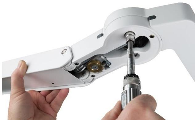
5. Vérifier l'alignement des éléments de roulement avant de contrôler la vis centrale.
