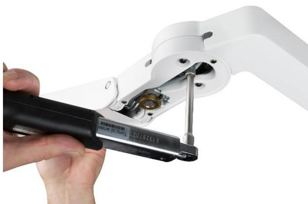
6. Après fixation de la vis centrale, serrer les deux écrous M6.
