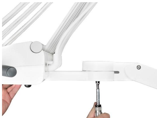
4. Vérifier l'alignement des éléments de roulement avant de contrôler le boulon central.
